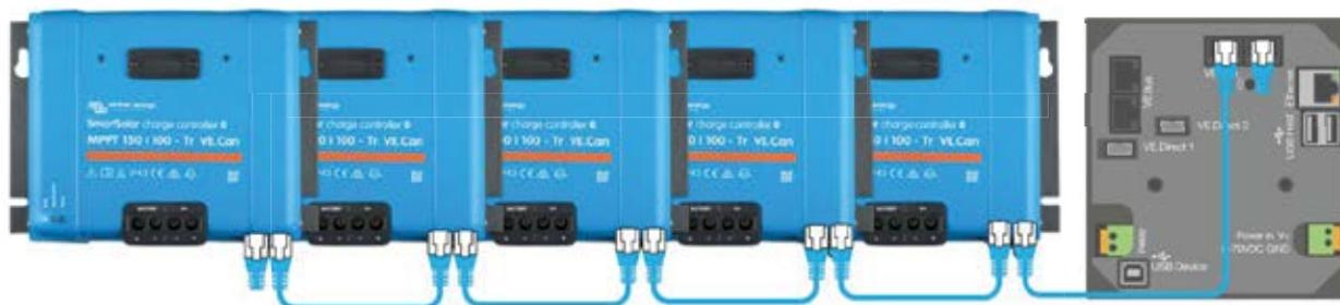
**Con VE.Can o Bluetooth, pueden conectarse en cadena hasta 25 o hasta 10 controladores de carga respectivamente para carga sincronizada y conectarse a su vez a un Color Control GX o a otro dispositivo GX. Cada Controlador puede supervisarse por separado, por ejemplo en un Color Control GX, en el sitio web VRM (VE.Can) o en un smartphone o iPad (Bluetooth)**
