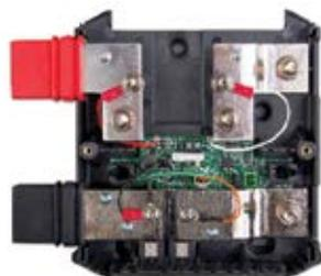
Lynx Shunt VE.Can (M8) sin cubierta
