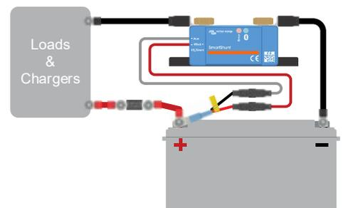
Medición de la temperatura de la batería
