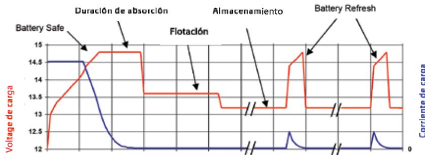
Fig. 4: Carga adaptable en 4 etapas de Victron
