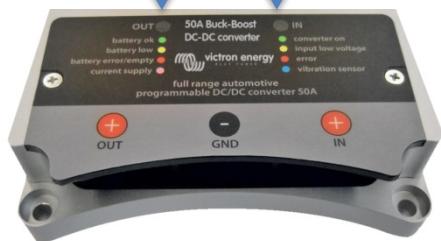
Indicador LED de salida Indicador LED de entrada
